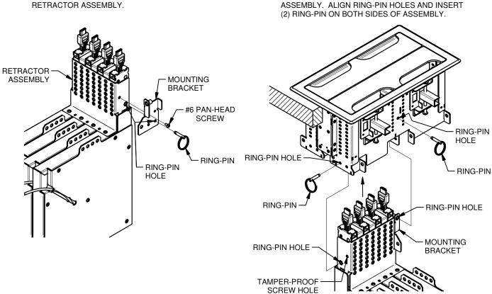
LS-2. SLIDE RETRACTOR ASSEMBLY INTO RT6-RD4
